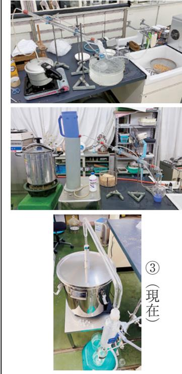
スギ、ヒノキの鉋屑からはスチーム（蒸し）蒸留法で精油を抽出している。実験装置の改良を経て、試料質量比で
